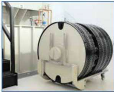
Poliertrommel vor Beladung in Säurepolierprozessbehälter Polishing drum prior to loading into the polishing tank
